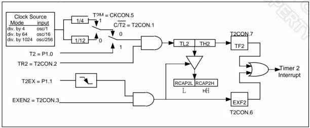
Figure 14. 16-Bit Capture Mode
